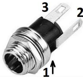
Slika 7. Raspored izvoda ženskog konektora za spoj sa ispravljačem. Plus na 1, minus na 2, a 3 ostaje slobodan
